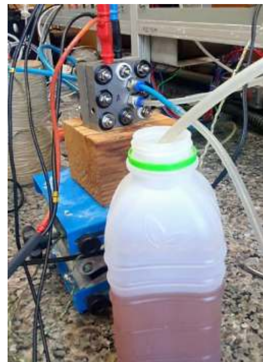
Modelo da célula a combustível com caldo de cana montado em laboratório
